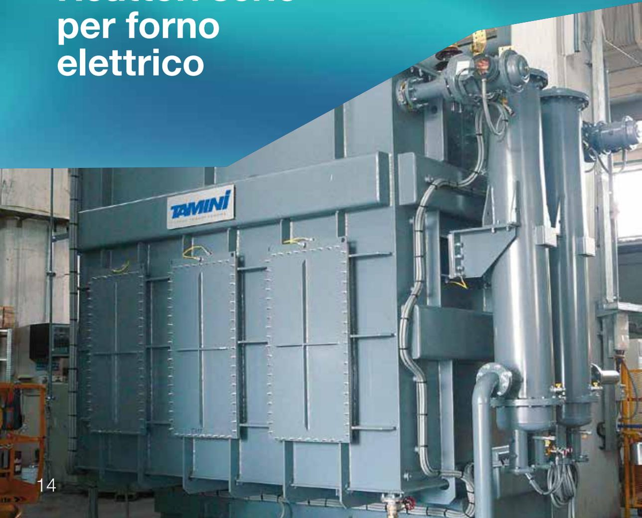
I reattori serie collegati al trasformatore da forno sono spesso utilizzati per stabilizzare la corrente dell'arco. Al fine di ottenere una migliore efficienza del processo di fusione, i reattori in serie possono essere dotati di commutatori per regolare il reattore in base alle esigenze del forno ad arco.
